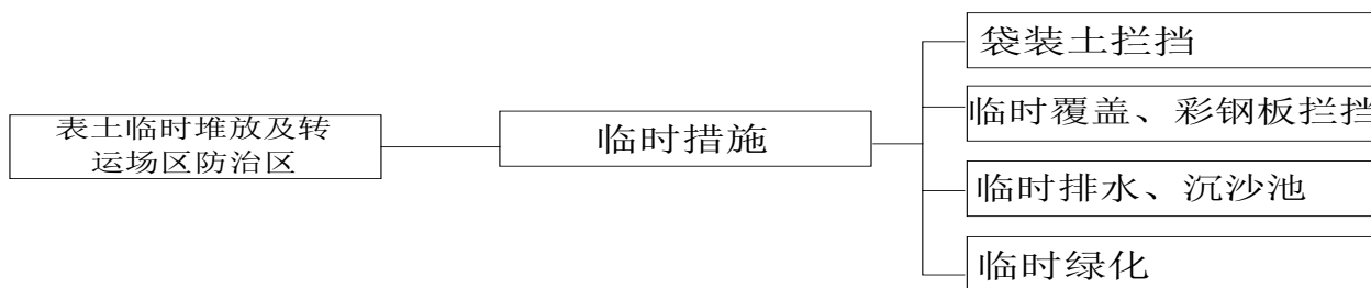
图 5-20 表土临时堆放及转运场区防治区水土流失防治措施体系
