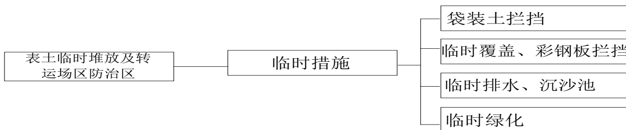
图 5-9 表土临时堆放及转运场区防治区水土流失防治措施体系
