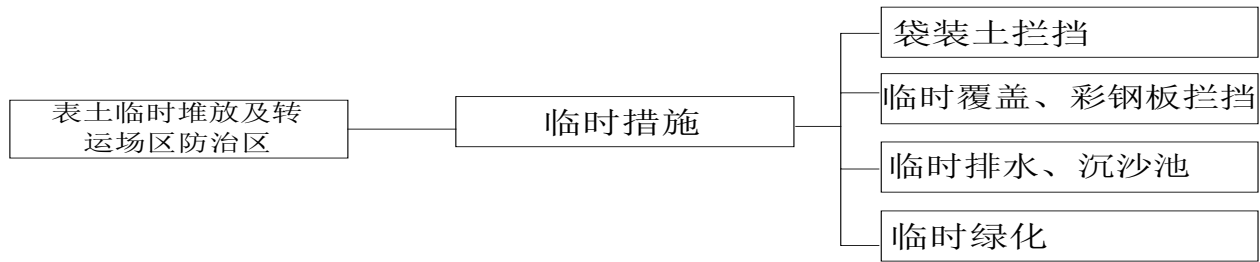
图 5-31 表土临时堆放及转运场区防治区水土流失防治措施体系
