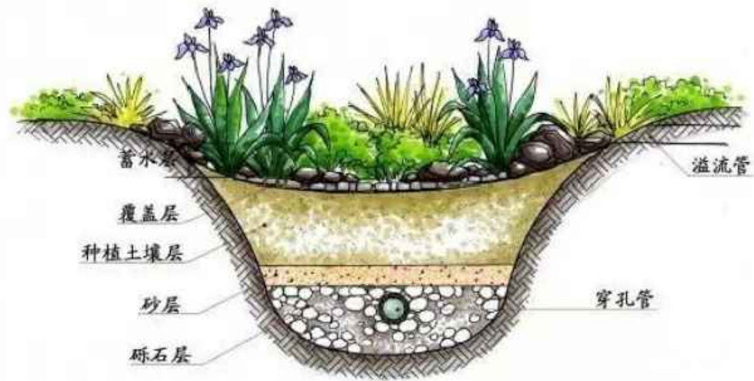
下沉式绿地构造示意图
