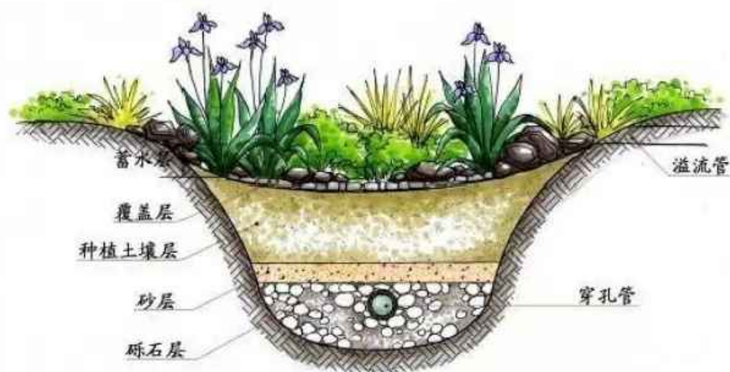
下沉式绿地构造示意图
