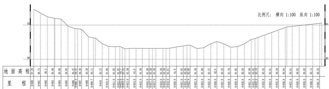
图 4-4 桩号 7+206 河道实测横断面
