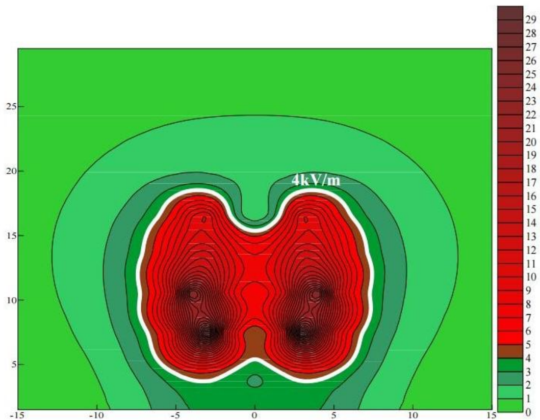
图 3-8 110-EC31S-Z3 型双回塔导线对地 7m 时工频电场强度等值线图 (kV/m)
