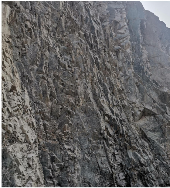
照片 4-3 YH1 南侧节理、裂隙发育面
