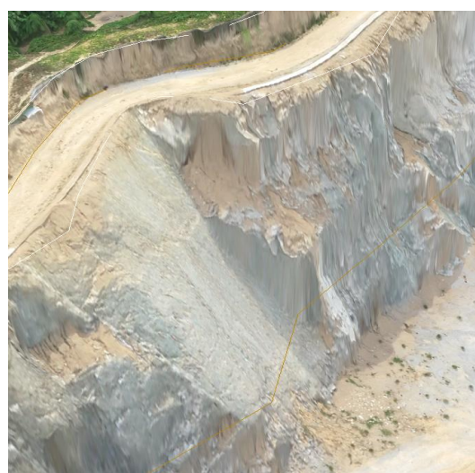
照片 4-6 YH3 隐患点裂隙发育面
