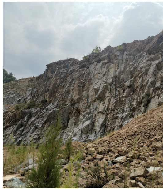
照片 4-4 YH1 东侧节理、裂隙发育面
