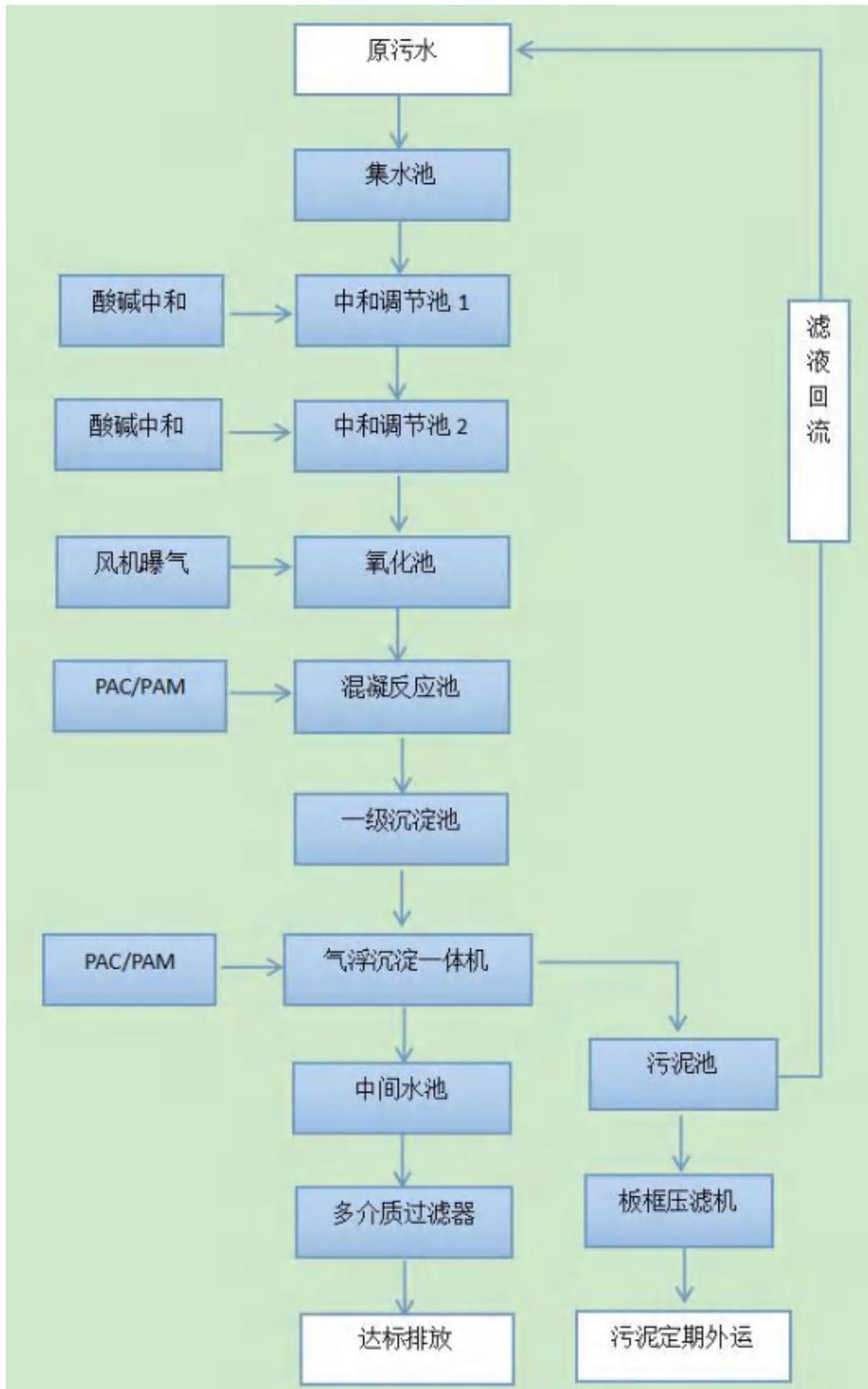
图 7.2-5 污水处理工艺流程图
