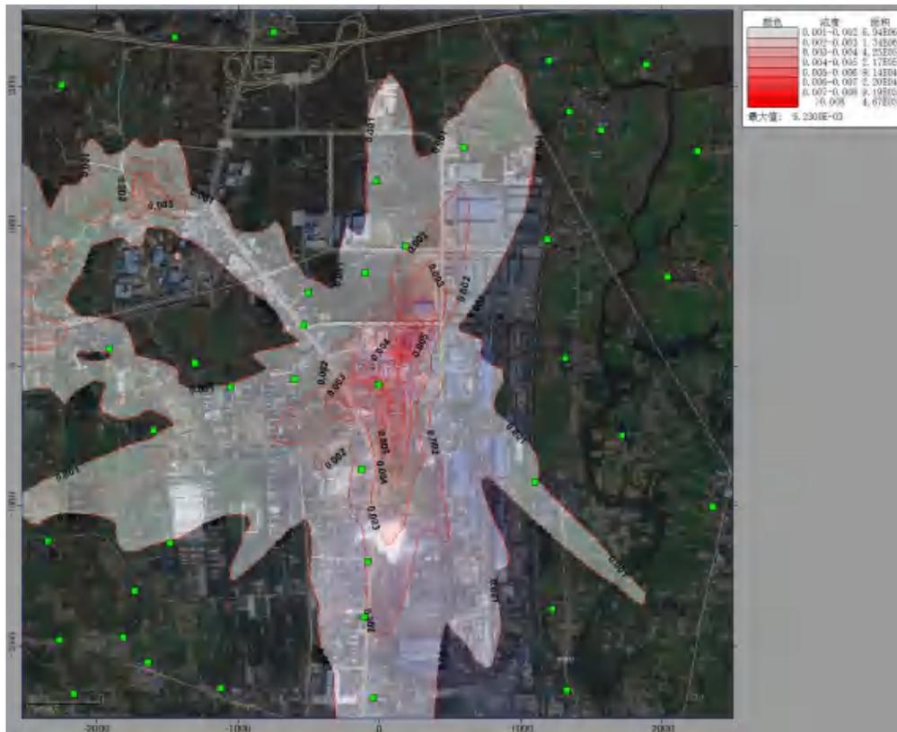
图 5.2-11 项目排放的 NO<sub>2</sub> 日平均浓度贡献值分布图 (单位: mg/m<sup>3</sup>)
