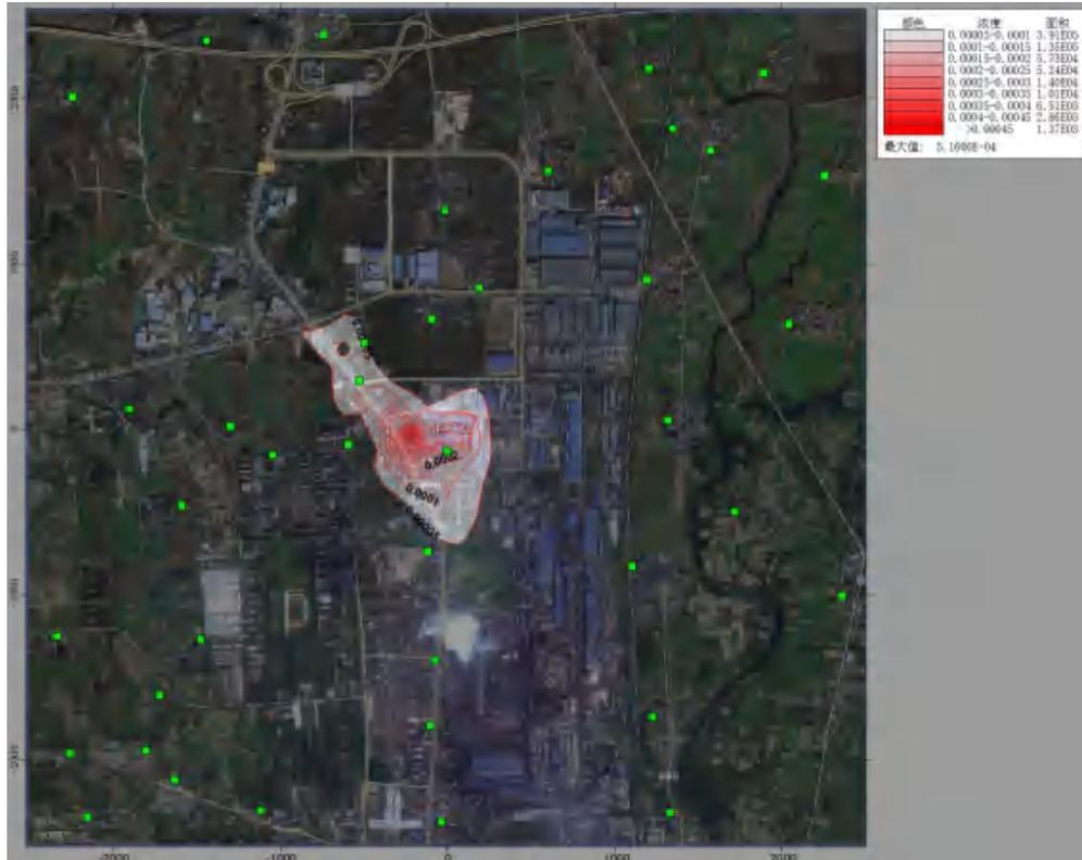
图 5.2-14 项目排放的 TSP 年平均浓度预测结果分布图 (单位:  $\text{mg}/\text{m}^3$ )
