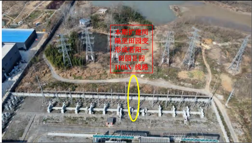
**图 2-3 本期茗阳 220kV 变电站 110kV 出线间隔扩建示意图**
