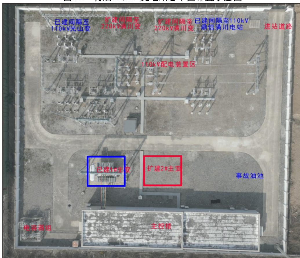
图2-1 付店110kV 变电站总平面布置示意图
