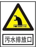
警告图形符号：黄色三角形背景，黑色污水排放口图标，下方有“污水排放口”文字。     | 污水排放口  |
