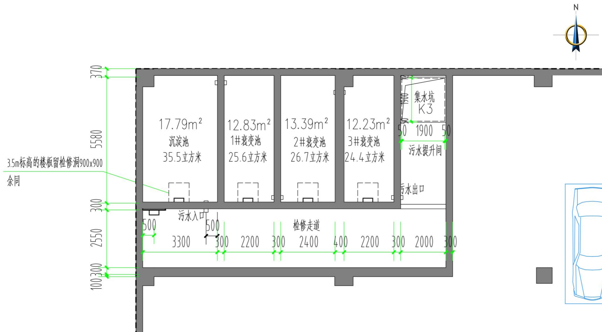
图 10.2-5 本项目核医学科衰变池结构平面设计图
