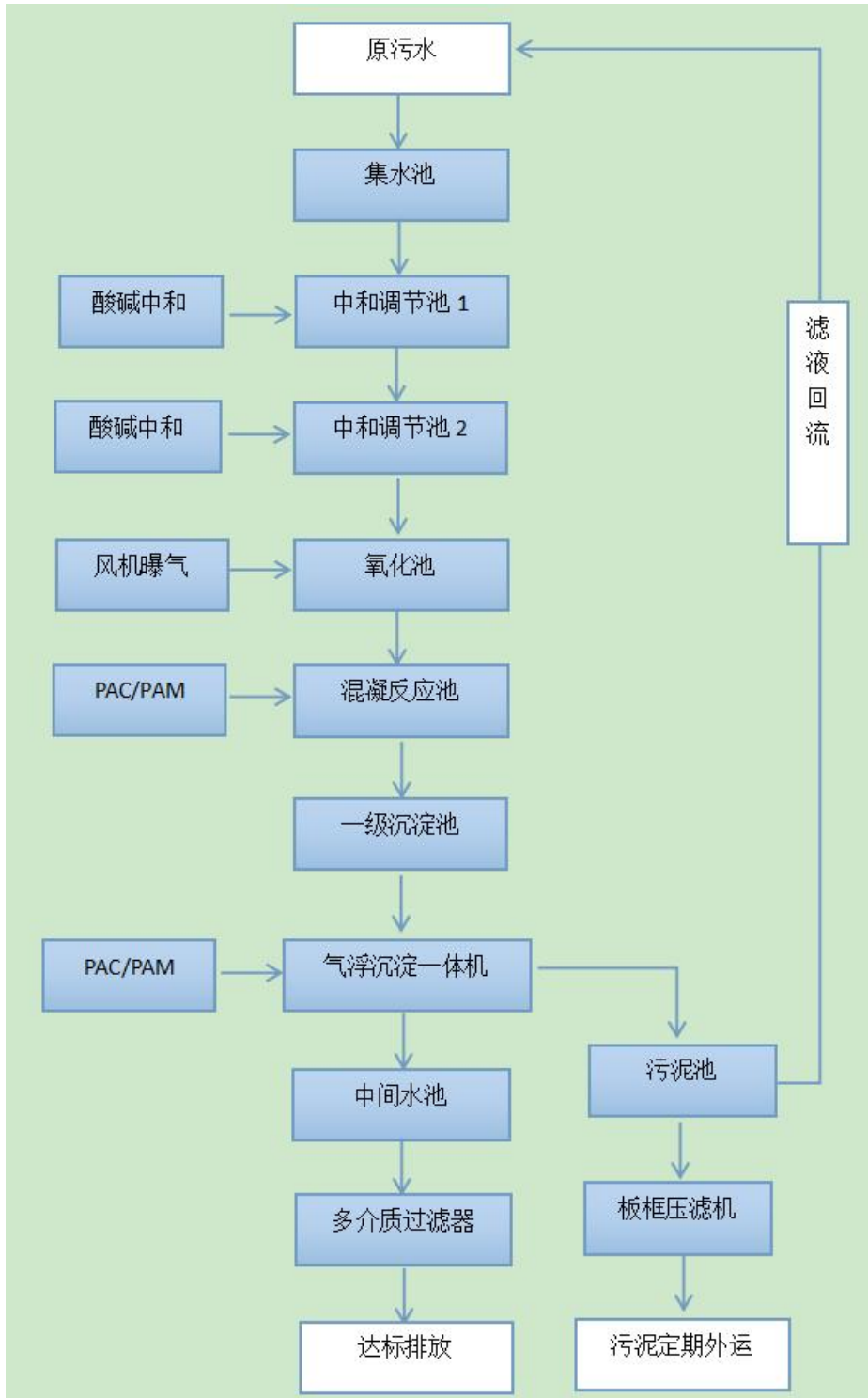
图 7.2-5 污水处理工艺流程图
