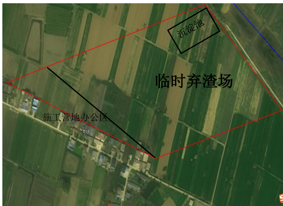
图 2.5-1 2 号临时弃渣场典型平面布置图
