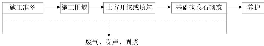
图 2.6-3 (1) 堤防工程主要工艺流程及产污环节图
