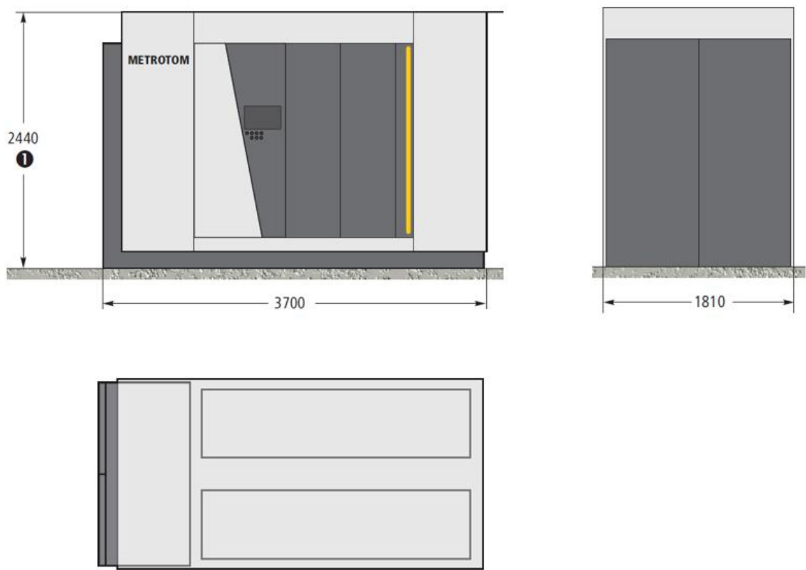
图 9-3 CT 扫描系统尺寸三视图 单位：mm
