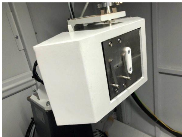
图 9-2 射线管带有铅防护罩的照片
